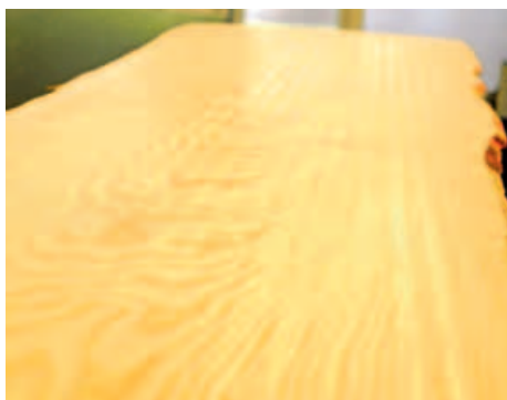
/ Borové prkno, 370 mm široké, bylo pro hřídel Silent-Power pouhou dětskou hrou. Při úběru třísky mezi 8 a 2 mm nenastávaly žádné problémy.
