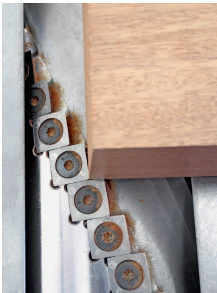
/ L'équipe d'essai parle d'une qualité fascinante de la surface. La photo montre très bien l'une des raisons qui est l'inclinaison par rapport à l'axe de la plaquette HM réversible, assurant une coupe tirante et des résultats de rabotage formidables.
