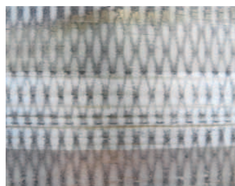
/ Великолепный (препарированный) тестовый образец, созданный при помощи множества небольших поворотных пластин, расположенных на строгальном ноже со спиралевидными ножами. Не видимый невооруженным глазом.
