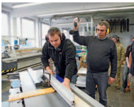
/ Pozoruhodnost: Hřídel Silent-Power je o 11 až 16 dB(A) tišší než standardní hoblovací hřídel se čtyřmi noži z HSS.
