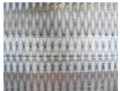
/ Una bonita muestra (preparada) creada a partir de las muchas plaquitas del eje de cepillo espiral. A simple vista no es reconocible.
