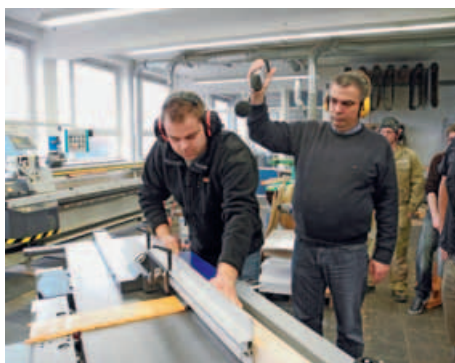
/ Кое-что на заметку: Строгальный вал Silent-Power значительно тише (11-16 дБ(А)) чем стандартный ножовой вал с четырьмя HSS-поворотными режущими пластинами.
