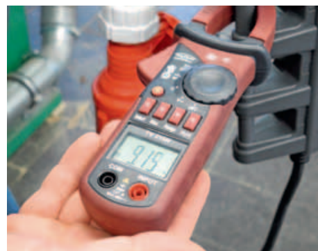
/ Měření odběru elektrického proudu: Rozdíly mezi oběma hoblovacími hřídeli jsou zanedbatelné a tedy nepodstatné při rozhodování o nákupu.
