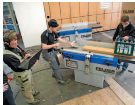
/ Der Testaufbau: zwei absolut baugleiche Felder-Hobelmaschinen vom Typ AD 951, bestückt mit den beiden unterschiedlichen Hobelwellen.
