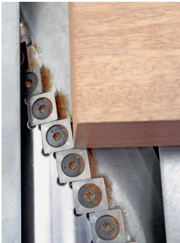
/ El equipo de prueba habla de una calidad de la superficie fascinante. La razón también es el ángulo del eje de las plaquitas HM, que se reconoce bien en la foto y que proporciona excelentes cortes y resultados en el cepillado.
