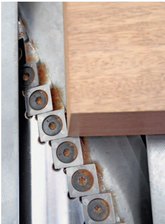
/ Zespół testujący stwierdza fascynującą jakość powierzchni. Składa się na to również dobrze rozpoznawalny na zdjęciu kąt między osiowy płytek 4-ostrzowych z węglika spiekane, który zapewnia skośne skrawanie materiału i wyjątkowe wyniki strugania.
