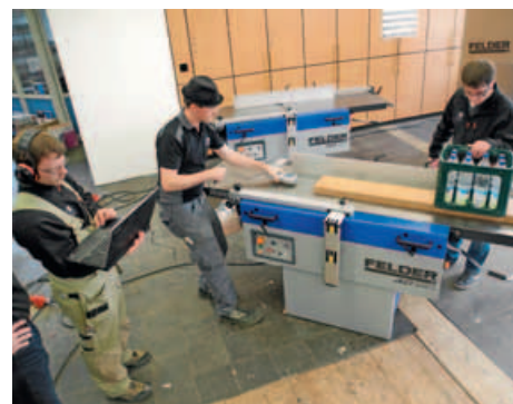
/ Configuración de la prueba: dos máquinas cepilladoras de tipo AD 951 idénticas, provistas con ambos ejes de cepillo diferentes.
