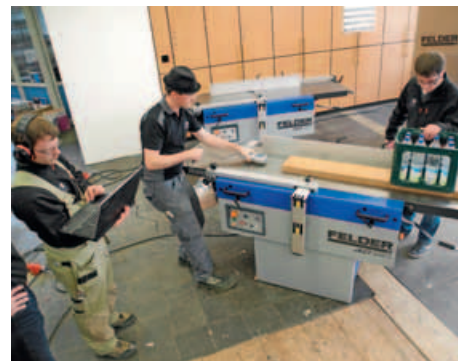
/ Структура теста: два станка Felder AD 951, имеющие абсолютно одинаковую конструкцию и оснащенные двумя разными строгальными ножами.
