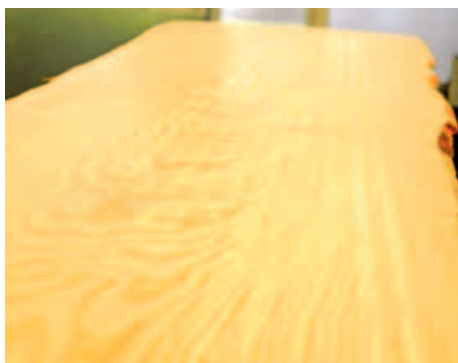
/ Доска из сосны шириной 370 мм для строгального вала Silent-Power оказалась просто детской игрушкой. Каких-либо сложностей при толщине снимаемого слоя в диапазоне от 2 до 8 мм не обнаружено.
