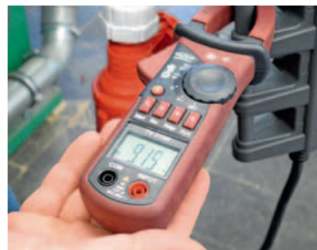
/ Mesurage du courant absorbé: Les différences des deux arbres de rabotage sont marginales. Elles ne sont pas significatives quant à un éventuel achat.
