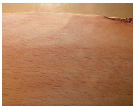
/ Buk ohoblovaný s posuvem 10 m/min: nejsou vidět žádné rázy nožů, v oblasti obratu minimální vytrhávání proti směru vláknů – super!
