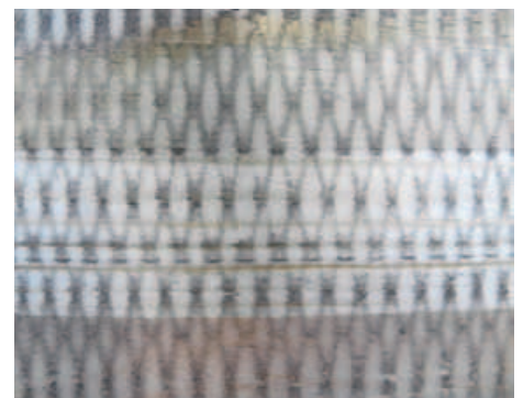
/ Ein schönes (präpariertes) Muster, erzeugt von den vielen kleinen Wendepunkten auf der Spiralhobelmesserwelle. Mit bloßem Auge ist dies nicht erkennbar.
