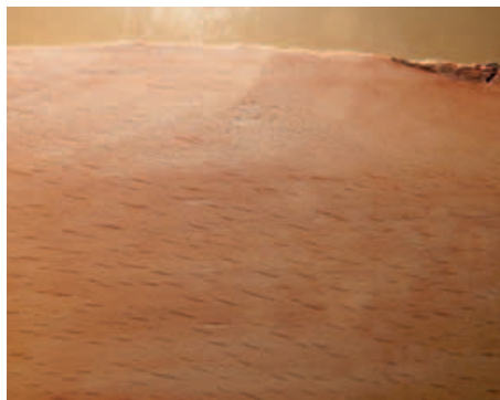
/ Buche mit einem Vorschub von 10 m/min gehobelt: keine Messerschläge zu sehen, im Wirbelbereich minimale Ausrisse gegen die Faserrichtung – super!
