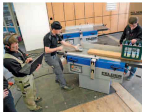
/ L'installation d'essai: Deux dégau-rabot absolument identiques de type Felder AD 951 équipées des deux arbres différents de rabotage.
