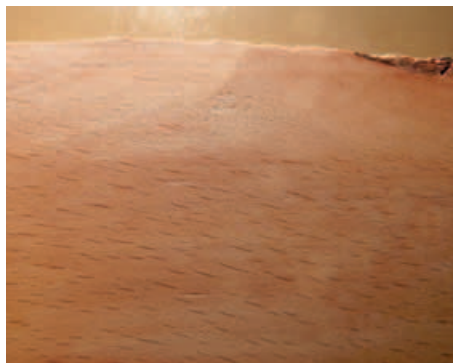
/ Du hêtre raboté avec une avance de 10 m/min: pas de traces de fer visibles, de minimes arrachages contre le sens des fibres - super!
