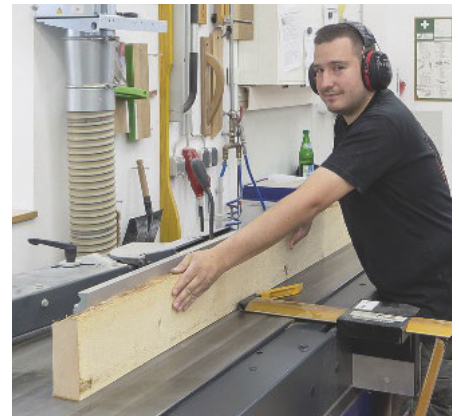
... und Rene Posch richtet sie auf der Hobelmaschine A 951 von Felder ab
