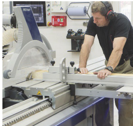
Heinrich-Ludwig Karl längt Bohlen an der Kappa 590 von Format4 ab ...
