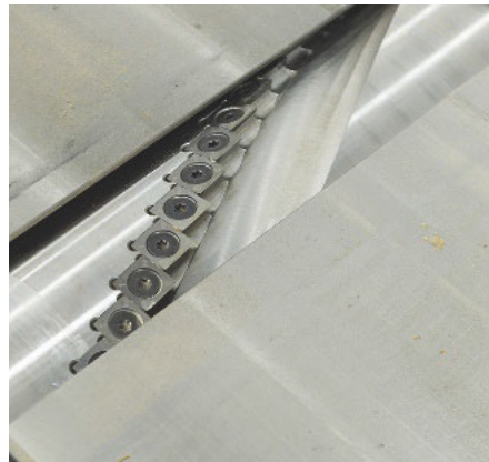
Die flüsterleise Spiralmesserwelle erzeugt hervorragende Flächen
