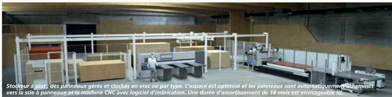
Manipulation des matériaux : des piles entières de panneaux agglomérés sont automatiquement transférées de la table de chargement élévatrice à la machine CNC avec logiciel d'imbrication, et déchargées après l'usinage.
