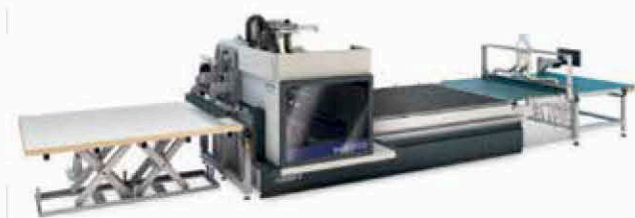
Manipulation des matériaux : des piles entières de panneaux agglomérés sont automatiquement transférées de la table de chargement élévatrice à la machine CNC avec logiciel d'imbrication, et déchargées après l'usinage.
